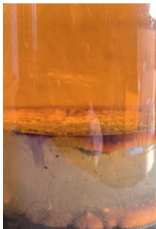
Op de foto zien we een binnenkant van een dieseltank. De afscheiding van water en vervuiling is goed zichtbaar. Na storting van verse brandstof wordt alles vermengd en degradeert de verse brandstof onmiddellijk!
